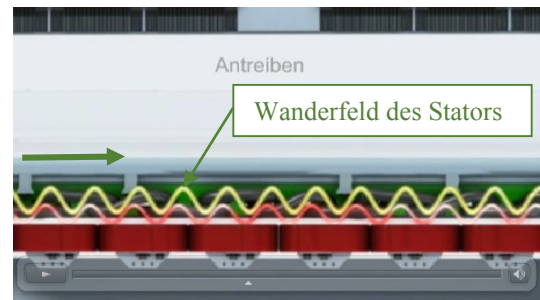
Abbildung 2: magnetische Felder im Langstator Aus: Technik - Antrieb
